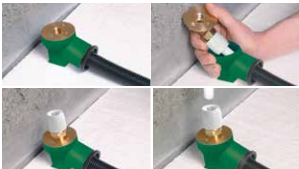
Fig.33: Procedimiento de instalación del codo extraíble con rosca hembra HX101
