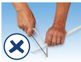
Fig. 7 No utilice una sierra para cortar la tubería Hep 2 O
