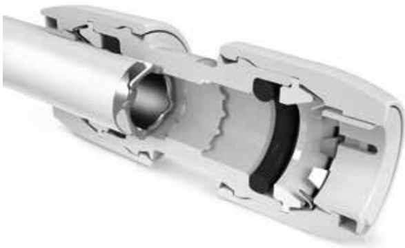
Fig.14: Corte de sección de un accesorio Hep20 para mostrar la tecnología In4Sure de reconocimiento de conexión
