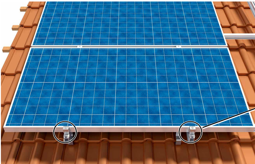
Monte los soportes finales y el clip de bloqueo
