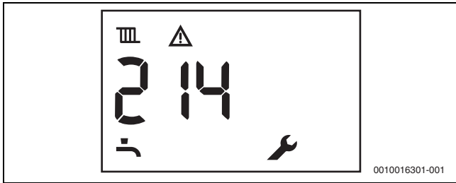
Fig. 72 Ejemplo: avería no bloqueante
