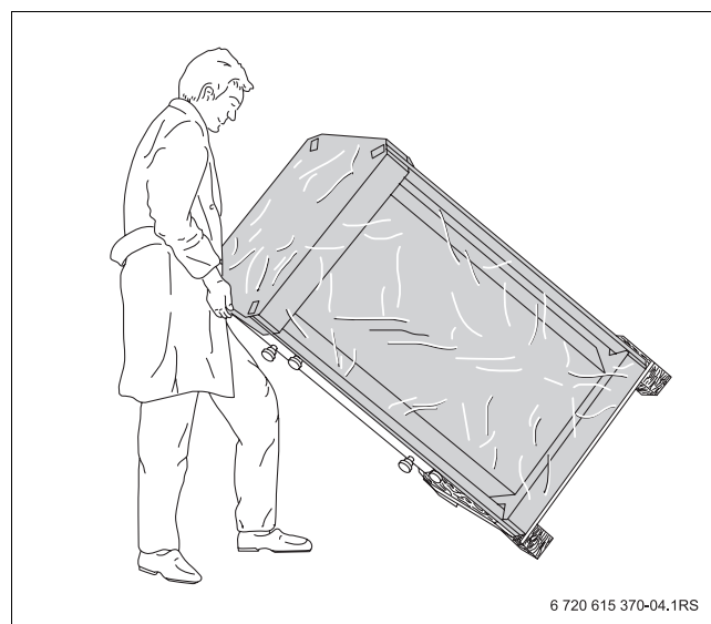
Fig. 4 Colocación del acumulador de agua caliente
