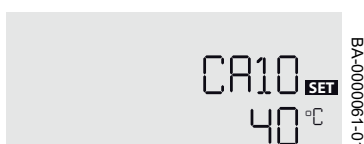
Fig.32 Temperatura de conexión
